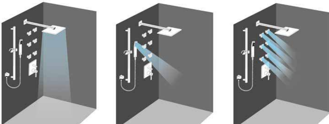
Ducha de empotrar con inversor. Rociador, Teléfono o Jets. Concealed shower with diverter. Shower head , handset or body jets. Douche encastrée avec dérivateur. Pomme de douche, set de douche ou jets.
